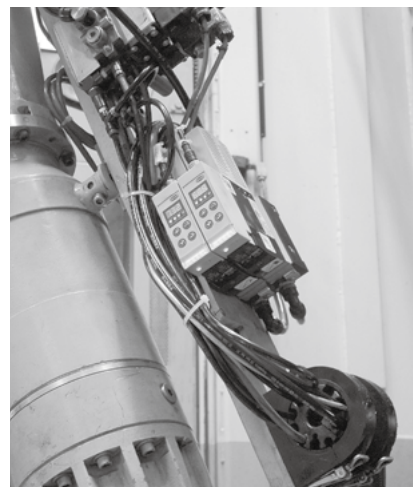
モニタリングによってシステムの不具合を検出するSXMP
