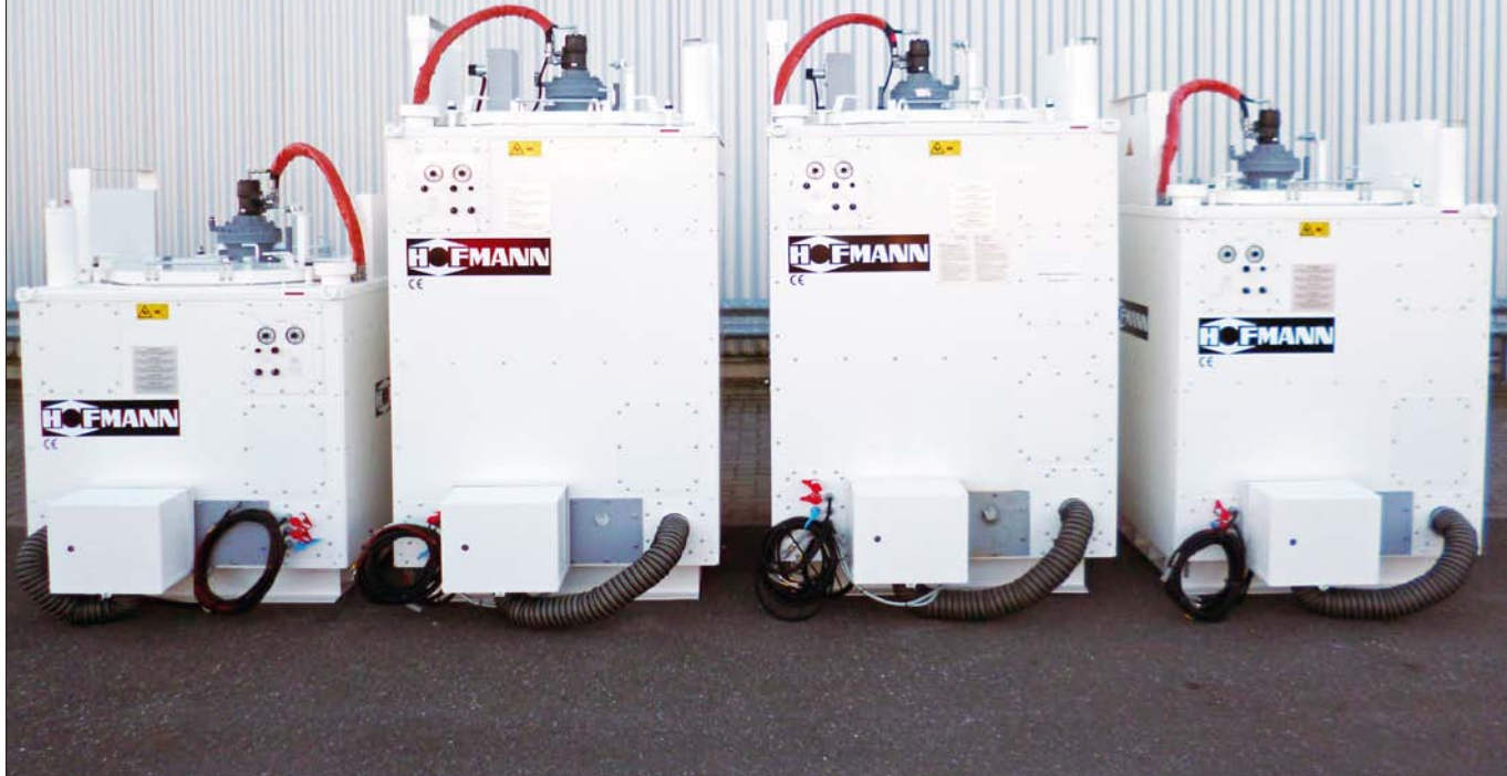
② ID100 - компактный передвижной модуль с котлом и силовой станцией - отсутствие прокладок, соприкасающихся с материалом - высокий момент вращения гидравлической мешалки - Только с пропановой горелки, силовая установка 3,1 кВт
