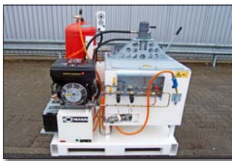
② ID100 - компактный передвижной модуль с котлом и силовой станцией - отсутствие прокладок, соприкасающихся с материалом - высокий момент вращения гидравлической мешалки - Только с пропановой горелки, силовая установка 3,1 кВт
