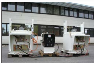
④ 2 x D350 с газовой горелкой на пропане, силовая установка 10кВт
