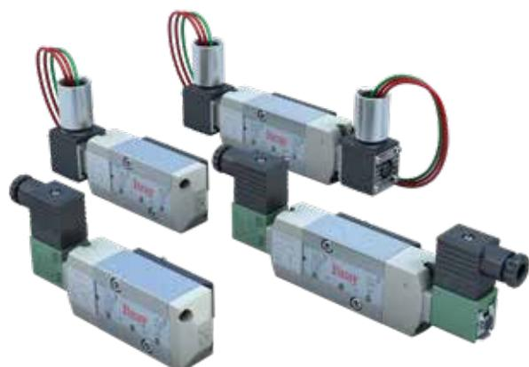
Ces unités peuvent être utilisées avec soit un rappel ressort soit des actionneurs double effet, sachant qu'il faut un mode de fonctionnement électrique marche/arrêt. Les unités présentent des raccroderment 1/4" NPT et des unités IP 66 DIN avec des connecteurs à presse-étoupe PG9, également disponibles avec un raccordement 1/2" NPT.
