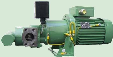
z.B. Bindemittelpumpe (Harze) nach ATEX mit doppelter GLRD, Quenchtvorlage und Temperaturüberwachung
