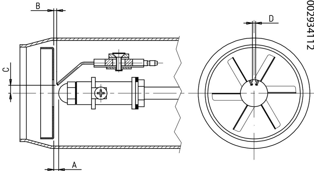
Dopo aver montato l'ugello, verificare il corretto posizionamento di elettrodi e disco, secondo le quote indicate in mm. E' opportuno eseguire una verifica delle quote dopo ogni intervento sulla testa.
