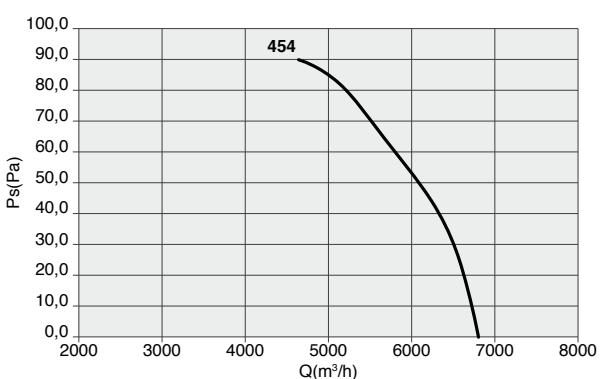
Le prestazioni aeronautiche sono rilevate in conformità alla norma EN ISO 5801/AMCA 210 con densità dell'aria standard avente peso specifico 1,2 Kg/m<sup>3</sup>. Alimentazione 230/1Ph/50Hz o 400/3Ph/50Hz.
